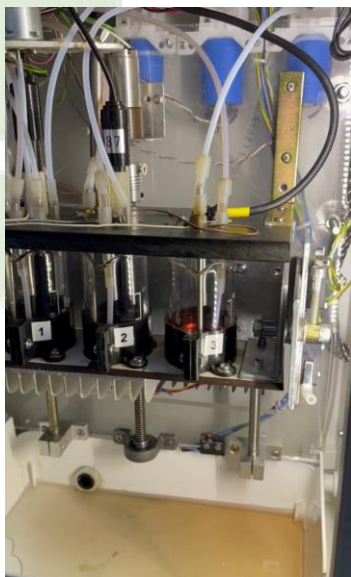
7° MODULO: riempimento becher 2 e 3 con salamoia fino ai sensori di livello per la determinazione della conducibilità elettrica (2) e della quantità di vapori organici volatili (3)
