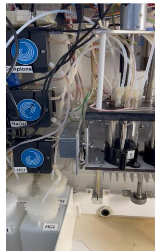
2° MODULO: carico 15 ml di salamoia per la determinazione dell'acidità libera mediante titolazione potenziometrica con NaOH
